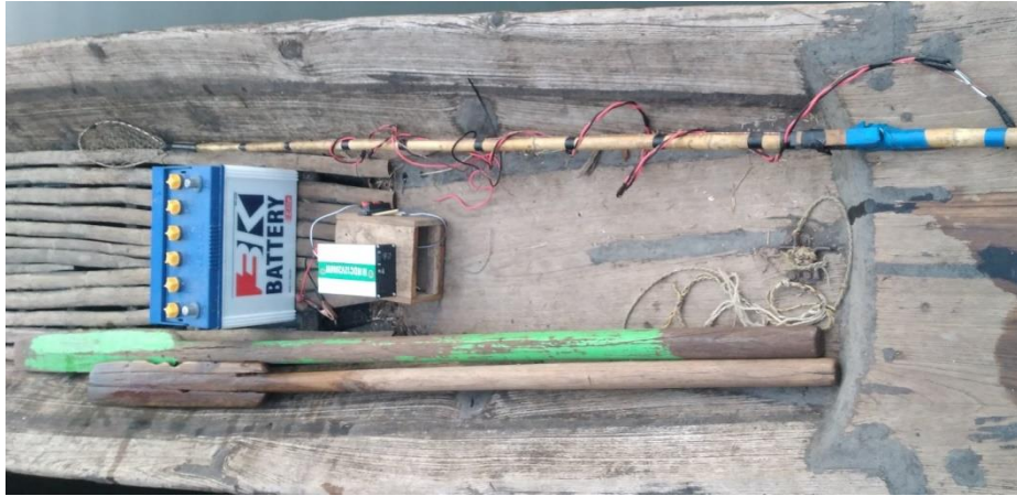
ဘက်ထရီရှော့တိုက်ရာတွင်အသုံးပြုသည့် ပစ္စည်းများ
